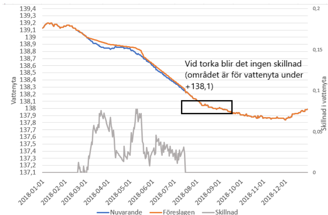
Figur 19. Diagrammet visar resultatet av en modellering av Åsnens vattennivå utifrån att i alla lägen tappa minsta möjliga mängd vatten enligt Watten i Sveriges föreslag till tappningsställare enligt figur 15 (orange linje). Jämförelse är gjord med hur tappningen faktiskt utfördes enligt nuvarande tappningsställare, F 77–2 (mörkblå linje). Skillnaden (ljusblå linje) mäts i den högra y-axeln och anger det antal meter som Åsnens vattenyta skulle vara lägre med Watten i Sveriges alternativa tappningsstrategi jämfört med den som faktiskt utfördes vid respektive tidpunkt. I maj uppstår största skillnaden på 0,08 meter, det vill säga 8 centimeters skillnad.
